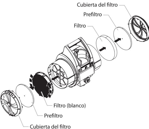
3. Limpie los filtros. Puede sacudir los filtros para sacar los contaminantes o usar aire comprimido para sopletear los contaminantes. Para material pegado difícil de separar, sumerja los filtros en agua jabonosa o espíritus minerales. Permita que los filtros se sequen completamente antes de volverlos a colocar en la turbina.
