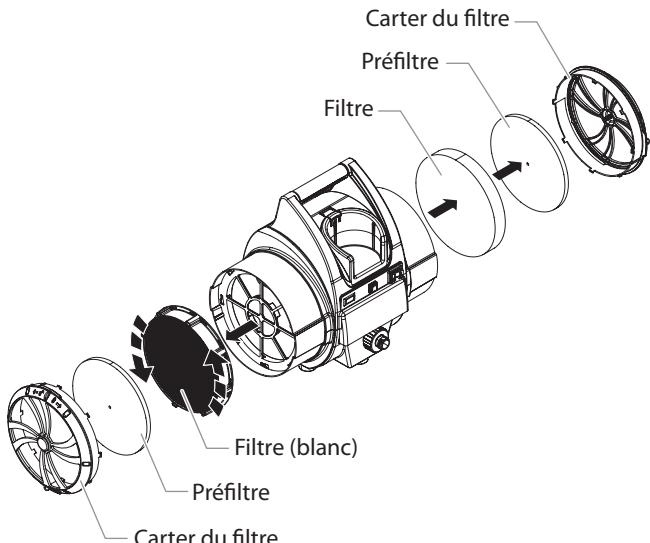
3. Nettoyer les filtres. Donner des petits coups sur les filtres pour évacuer les contaminants ou utiliser de l'air comprimé pour les chasser. Pour les matières qui ne sont pas évacuées facilement, tremper les filtres dans de l'eau savonneuse ou dans de l'essence minérale. Laisser sécher complètement les filtres avant de les remonter dans la turbine.
