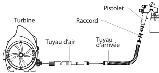
**IMPORTANT : Ne raccordez pas le tuyau court d'arrivée d'air directement à la turbine, car cela endommagera le tuyau.**
