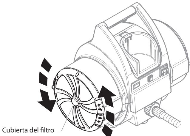
2. Retire cada conjunto de filtro (prefiltro y filtro), de la carcasa del filtro a cada lado de la turbina.
