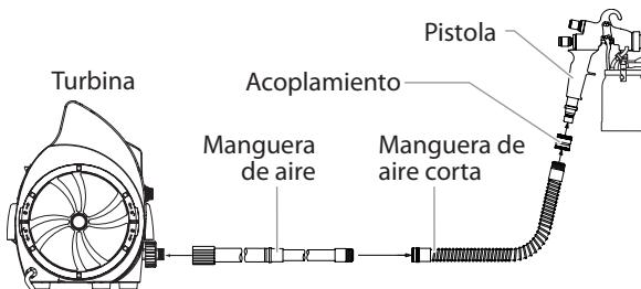
**IMPORTANTE:** No conecte la manguera de aire corta con conexión flexible directamente a la turbina, ya que se puede dañar la manguera.
