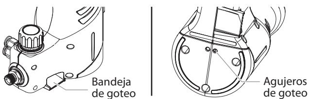
17. Quite Transfer Pump de la turbina e incline hacia el lado y adelante para drenar cualquier exceso de solvente de la bomba.
