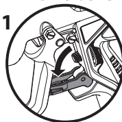
Abzug verriegelt (Spritzpistole sprüht nicht)
