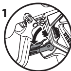
Спусковой крючок заблокирован (распыление невозможно)
