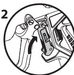
Pistola destravada (a pistola pulverizará)
