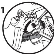
Gatilho bloqueado (a pistola não pulveriza)
