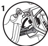
Aftrækker er låst (pistolen sprøjter ikke)
