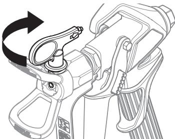
3. Soulever la soupape PRIME/SPRAY à la position SPRAY.
