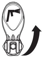
12. Appuyer sur la détente en visant le contenant métallique pour purger le produit du flexible, jusqu'à ce que le solvant s'écoule du pistolet.
