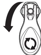
6. Régler la pression pour le rapid clean par pulsations en mettant le bouton de régulation à la position RAPID CLEAN.
