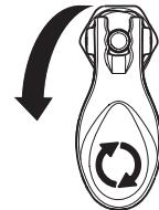
6. Fije la presión en RAPID CLEAN girando la perilla de control de presión a su posición RAPID CLEAN.
